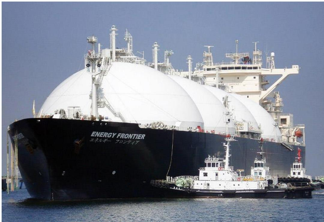
**Nave per il trasporto di gas liquido della flotta della British Gas**
